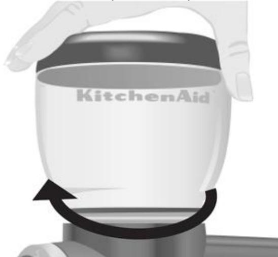
2. Задвиньте контейнер для молотого кофе на платформу. При этом немного сожмется уплотнительная пластина на корпусе электродвигателя. Убедитесь, что контейнер установлен в середине платформы.
