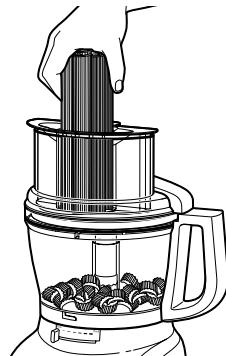
Нарежьте продукты таким образом, чтобы они поместились в подающую трубку вертикально или горизонтально, и поместите их в подающую трубку в нужном положении. Измельчите, применяя равномерное давление.
