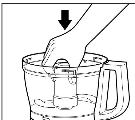
4. Установите крышку рабочей чаши в пазы таким образом, чтобы она плотно закрывала чашу.
