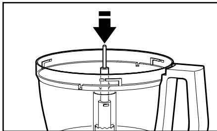
2. Взяв регулируемый режущий диск при помощи двух отверстий для пальцев, вставьте его в адаптер диска таким образом, чтобы пазы в форме буквы L на диске совпали с пазами на адаптере. Для этого поместите диск на адаптер и медленно вращайте его до совпадения пазов.
